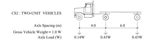
FIGURE 6.1.2 CS2 Load Evaluation Truck
